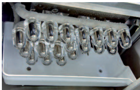
Verdampferfinger mit kristallklaren Hohleis Kegeln am Ende des Produktionsprozesses
